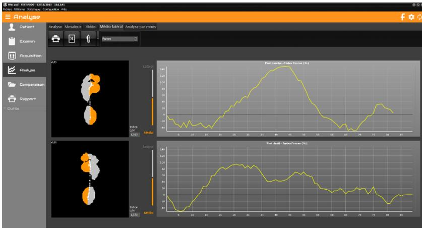
Le pied est divisé en 2 zones de part et d'autre de la "Gaitline" (courbe d'évolution du centre de pression). Les couleurs **Gris** (Latéral = côté extérieur) et **Orange** (Médial = côté intérieur) permettent de visualiser les zones utilisées pour les calculs.
